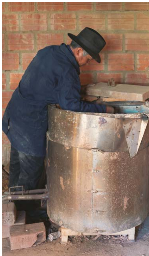
Figura 49: Horno industrial eléctrico para cocción de cerámica. Fuente: Fotografía de Milton Eyzaguirre (Archivo MUSEF).
