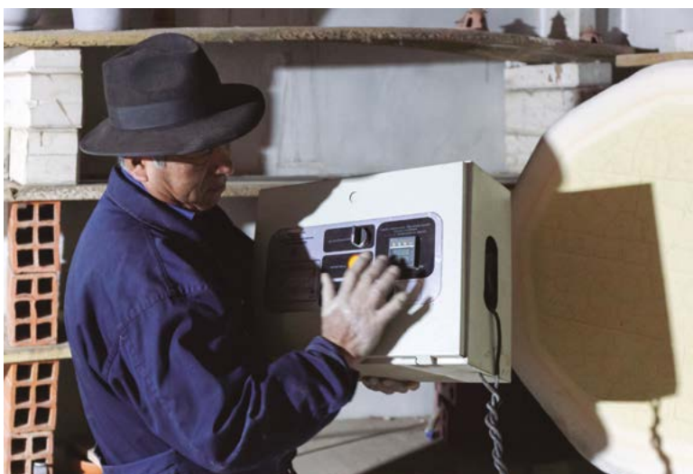
Figura 26: Termómetro industrial para la cocción de la cerámica. Debe estar entre los 800 y 1200 grados centígrados. Fuente: Fotografía de Milton Eyzaguirre (Archivo MUSEF).
